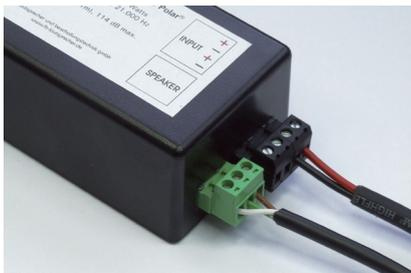
Kabel vom DE Lautsprecher bei SPEAKER anstecken (grün). Einen INPUT-Stecker (schwarz) an Lautsprecherkabel schrauben. Der zweite INPUT-Stecker kann zur Parallelschaltung mit einem zweiten Lautsprecher verwendet werden.
